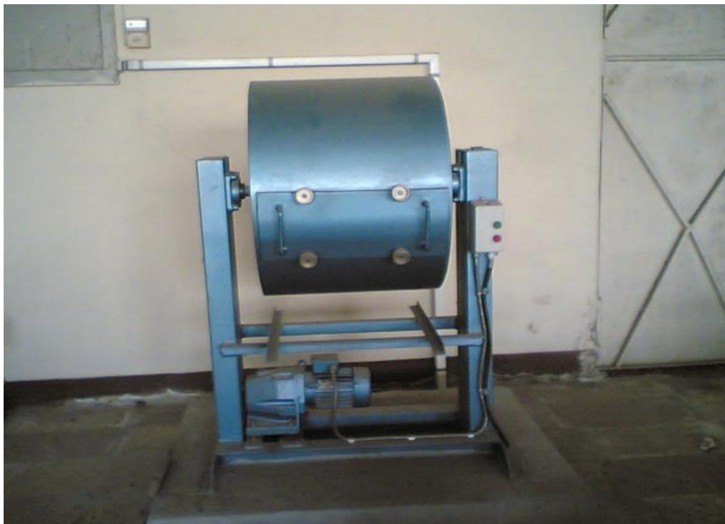
جهاز اختبار البرى (Test Apparatus Los Angeles)
