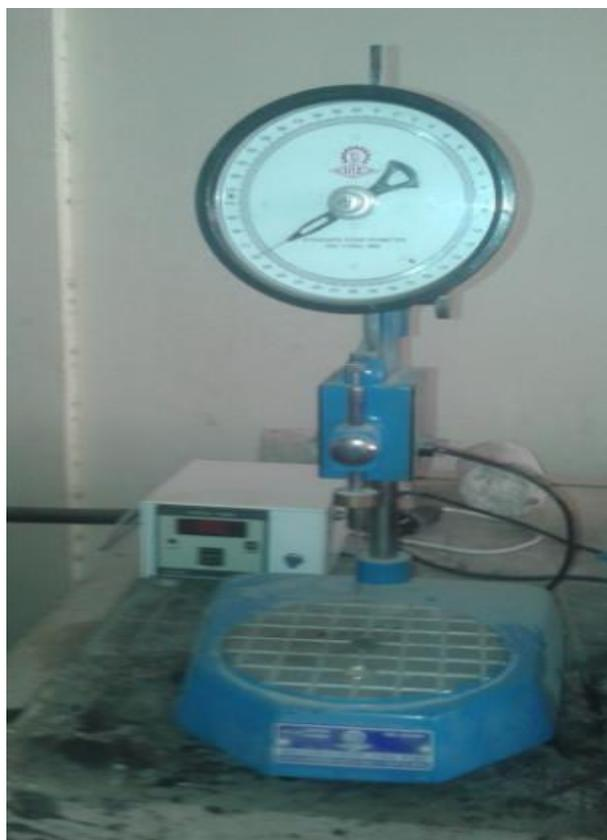
جهاز اختبار الإختراق ( Penetration test )
