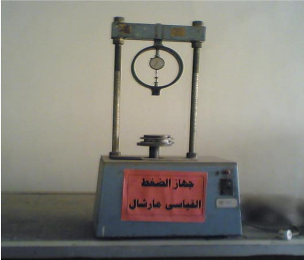
جهاز الضغط القياسى لمارشال (Test Machine Marshall)
