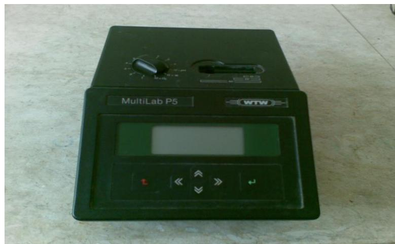
يقوم الجهاز بقياس التلوث العضوي والكيميائي للمياه (مياه الشرب العادية و مياه المزارع السمكية وأيضاً اللبن ) إلى جانب قياس نسب كل من الأكسجين و عسر المياه .
