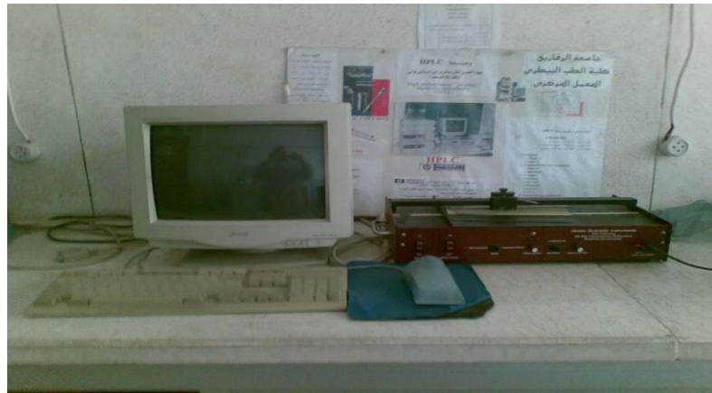
هو جهاز مخصص لقراءة العينات المفصولة على جل (Gel) بطريقة الفصل الكهربائي للبروتين (Electrophoreses).
